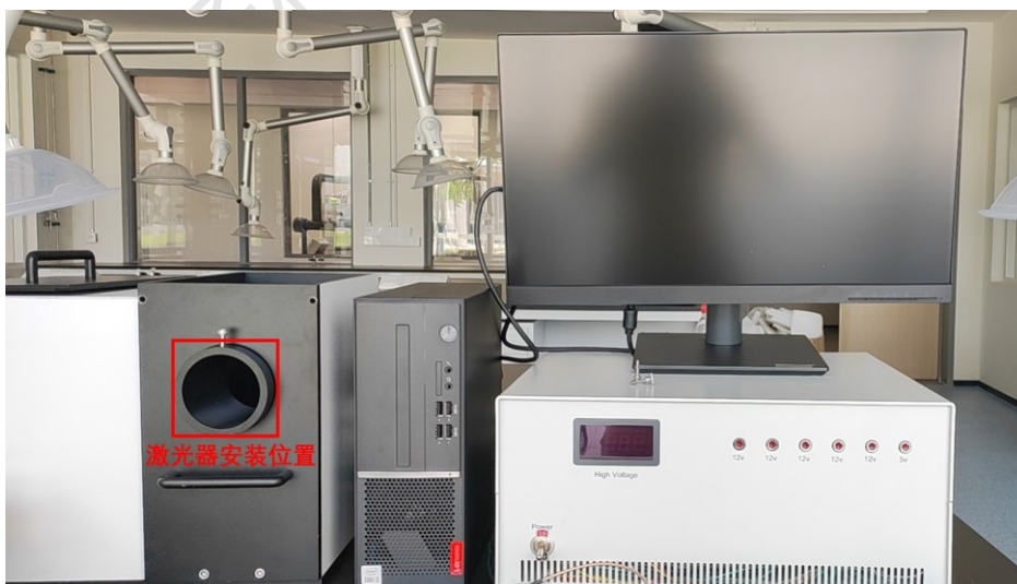
图 6-1 激光器安装位置
