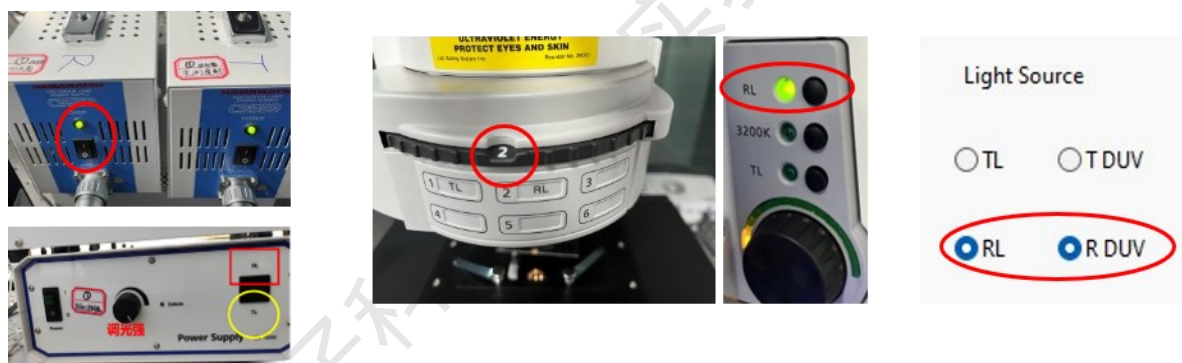
图 6.6. 反射光谱测量模式下硬件和软件各部分设置。
