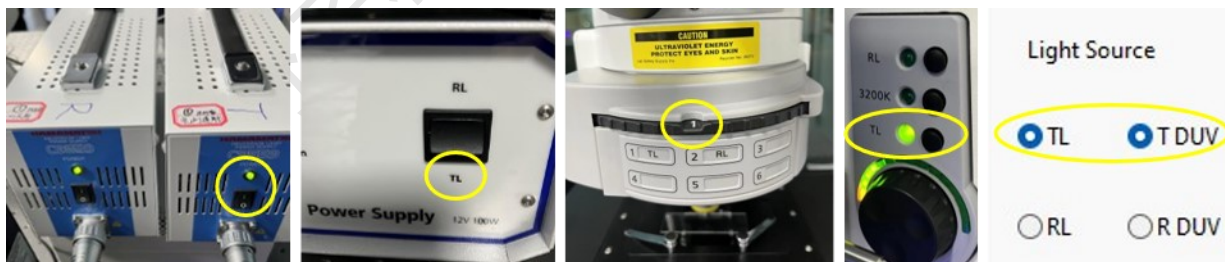
图 6.10. 透射光谱光路调整和测量模式下硬件和软件各部分设置。
