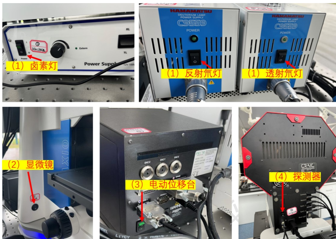
图 6-2 CRAIC 20/30PV Pro 紫外可见近红外显微光谱仪主机及配件开关位置。
