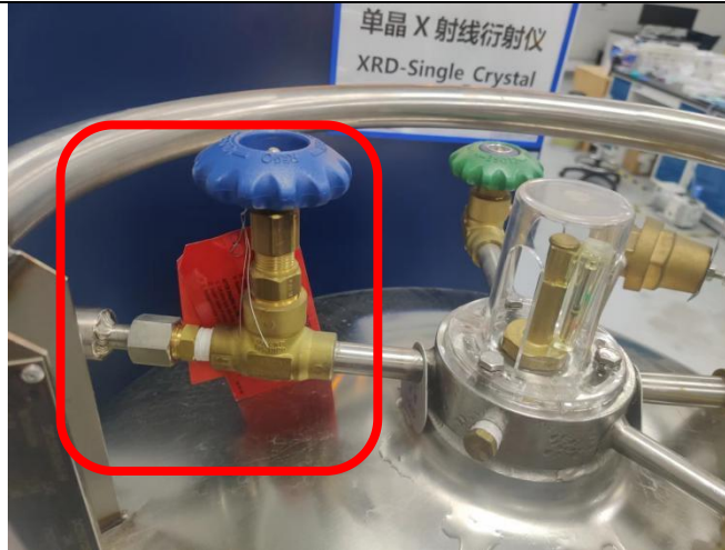
Figure 3. 大液氮罐的液体阀门
