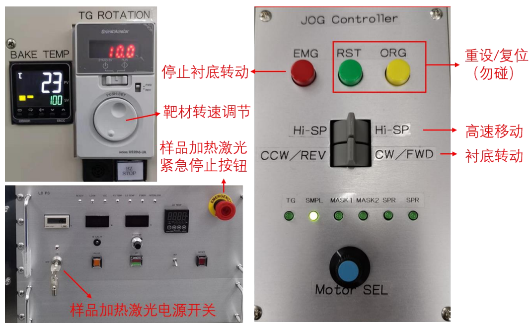
图 9. 硬件控制系统
