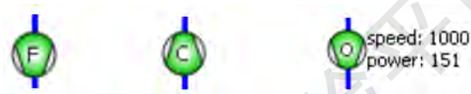
图 7.5 Triton 系统中用于气体循环的泵的图标，从左到右依次是前级泵， 3 He 压缩机和涡轮泵（开启状态）。
