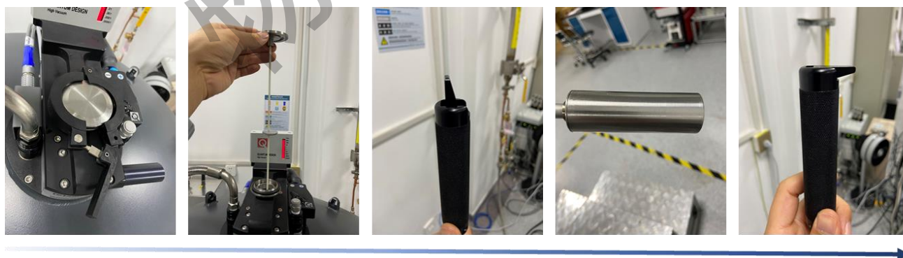
图 6.9 安装样品步骤示意：从左到右依次为拆卡箍、隔热串、装样器锁扣打开、装样器底部、装样器锁扣关闭
